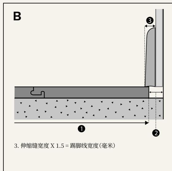
确保地板能在墙面装修板件下面自由移动。
